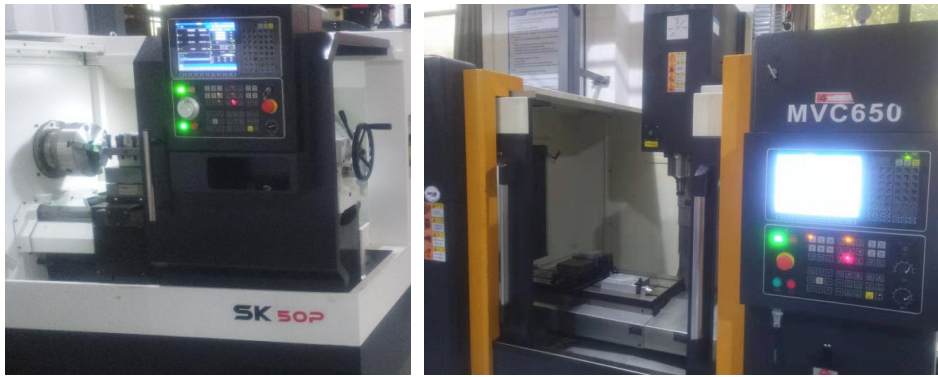
图 3 完成数控系统升级改造的数控车床、铣床
